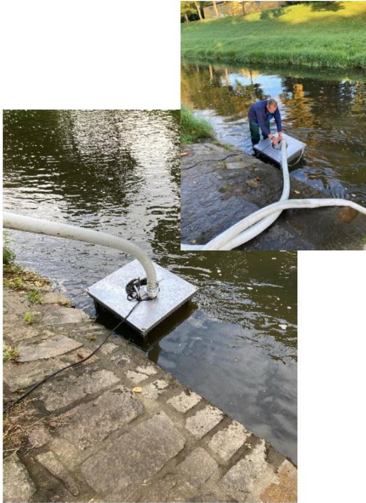
Vereinfachte Wasserentnahme mit Tauchpumpe
