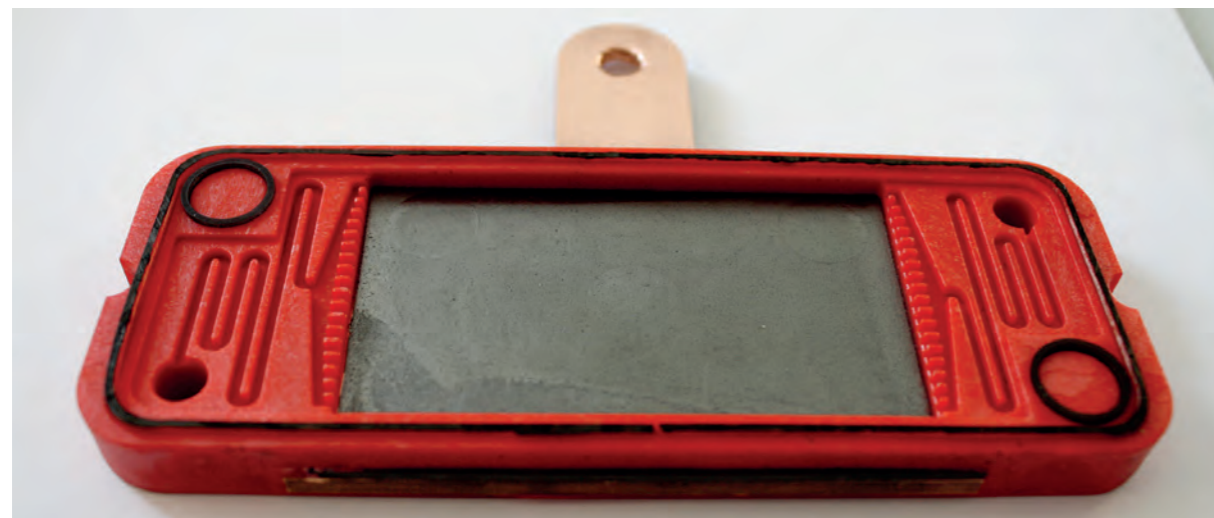
Abbildung 2: Im Spritzguß gefertigter Rahmen mit angegossenem Monopolarplatte und Stromkollektor.
