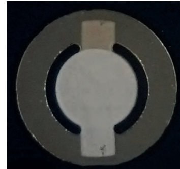
Abbildung 9: Freischwinger, thermisch und mechanisch entkoppelter Resonator
