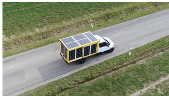
Das Konsortium des Forschungsprojektes „Street“ um das koordinierende Institut für Solarenergieforschung Hameln (ISFH) hat einen Prototyp eines leichten Nutzfahrzeugs auf die Straße gebracht, der mit hocheffizienter fahrzeugintegrierter Photovoltaik ausgestattet ist. Das Besondere daran: Die aus dem Sonnenlicht konvertierte Energie kann in das Hochvolt-Bordnetz eingespeist und damit direkt zur Reichweitenverlängerung genutzt werden.
