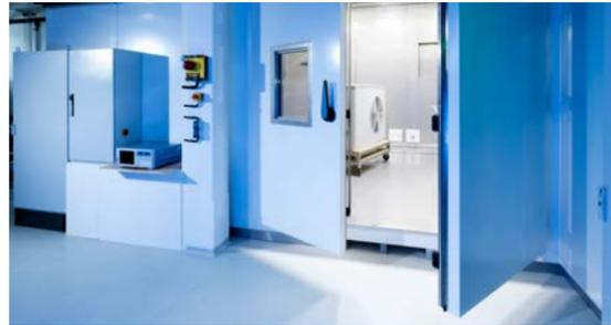
Das Institut für Solarenergieforschung Hameln (ISFH) entwickelt eine Prüfumgebung, mit der Wärmepumpen in verschiedenen realen Szenarien in Echtzeit getestet werden. So können verschiedene Gebäudetypen, Heizsysteme und regenerativ erzeugte Energien unter frei wählbaren meteorologischen Randbedingungen experimentell abgebildet werden.
