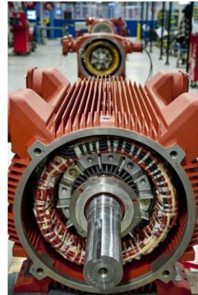
*Elektromotor für den Verdichtereinsatz*
